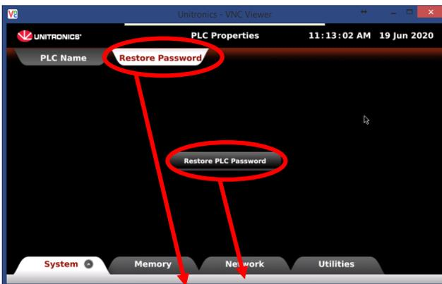
Cliquer sur le 2nd onglet « Restore Password » puis sur le bouton « Restore PLC Password »
