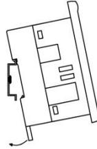
2. S'il est monté, l'automate se trouve sur le rail DIN comme indiqué sur la figure droite.
